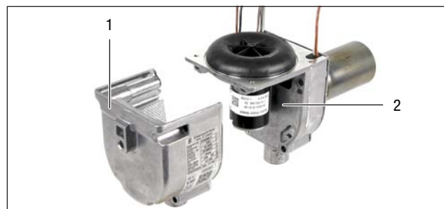
1 Recouvrement du moteur électrique 2 Sous-groupe du « ventilateur avec chambre de combustion »
