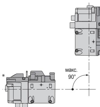
Отопительный прибор в монтажном положении стоя (нормальное положение\*) с допустимым отклонением до монтажного положения лежа.
