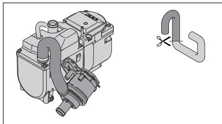
Для монтажа водяного насоса на отопительном приборе использовать универсальный водяной шланг, № по каталогу запчастей 25 2526 80 01 02, укоротив его до необходимой длины.
