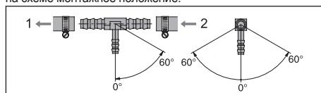
1 Направление подачи – к топливному баку
