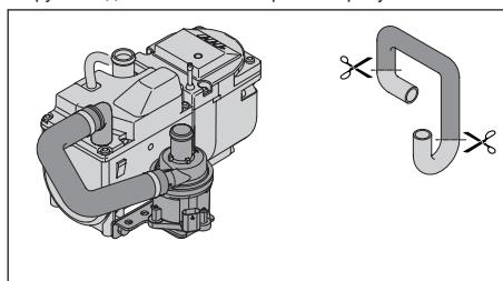
Водяной насос с направленным вверх выпускным патрубком закреплен на отопительном приборе снизу, со стороны разъема для подачи топлива. Выпускной патрубок водяного насоса смотрит вверх.
