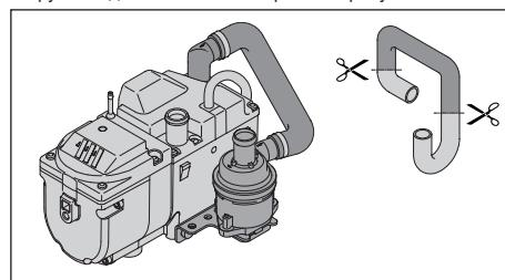
Водяной насос с направленным вверх выпускным патрубком закреплен на отопительном приборе снизу, со стороны выпускного патрубка. Выпускной патрубок водяного насоса смотрит вверх.
