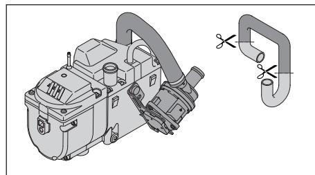
Водяной насос закреплен выпускным патрубком вниз на отопительном приборе со стороны выпускного патрубка воды. Выпускной патрубок водяного насоса смотрит вверх.
