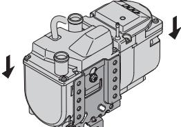
4. Закрепить отопительный прибор с помощью 2 винтов с шестигранными головками M6 x 12 (с клеевым покрытием) на держателе (момент затяжки: 6+2 Нм).
