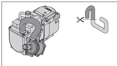
Водяной насос закреплен выпускным патрубком вниз на отопительном приборе со стороны разъема для подачи топлива. Выпускной патрубок водяного насоса смотрит вверх.
