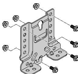
2. Вкрутить специальный винт M6 x 17 в отопительный прибор.
